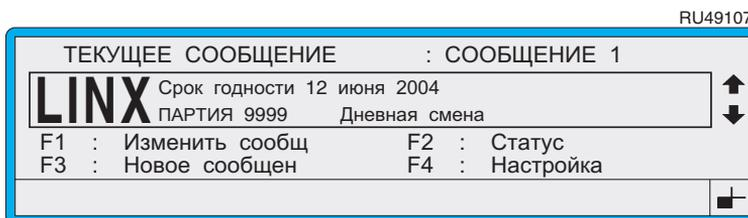
**Рисунок 4-40** Пример сообщения, отображаемого в экране Текущее сообщение
