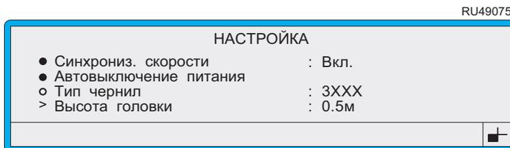
**Рисунок 5-18 Меню Настройка: Опция Высота головки**
