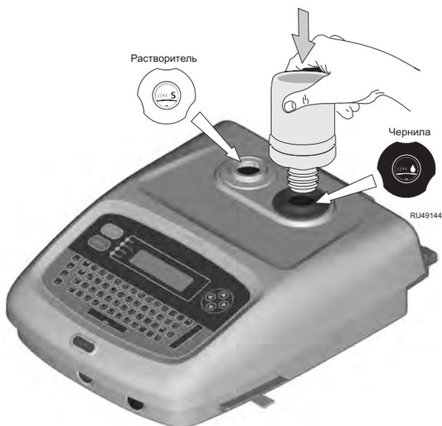
**Рисунок 7-14 Дозаправка принтера чернилами и растворителем**
