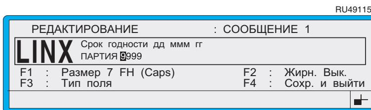
**Рисунок 4-28 Экран Редактирование: Последовательный номер**
