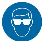
**ПРЕДУПРЕЖДЕНИЕ: ОПАСНЫЕ ЧЕРНИЛА И РАСТВОРИТЕЛИ. ИСПОЛЬЗОВАТЬ ЗАЩИТНЫЕ ОЧКИ И ПЕРЧАТКИ, УСТОЙЧИВЫЕ К ВОЗДЕЙСТВИЮ РАСТВОРИТЕЛЯ В ТЕЧЕНИЕ ВСЕГО ВРЕМЕНИ ВЫПОЛНЕНИЯ СЛЕДУЮЩЕЙ ОПЕРАЦИИ. НЕВЫПОЛНЕНИЕ ПРЕДОСТЕРЕЖЕНИЯ ОБ ОПАСНОСТИ МОЖЕТ СТАТЬ ПРИЧИНОЙ РАЗДРАЖЕНИЯ И МЕСТНОГО ПОВРЕЖДЕНИЯ ГЛАЗ, КОТОРОЕ СО ВРЕМЕНЕМ ПРОХОДИТ, И НЕАЛЛЕРГИЧЕСКОГО КОНТАКТНОГО ДЕРМАТИТА.**
