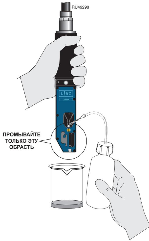
Рисунок 7-15 Очистка печатающей головки
